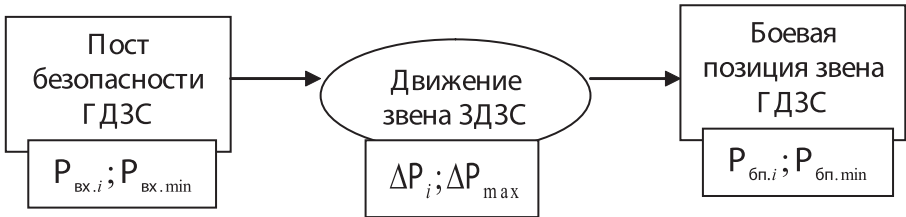
Рис. 2.1. Распределение давления кислорода в баллонах КИП на маршруте движения звена ГДЗС
